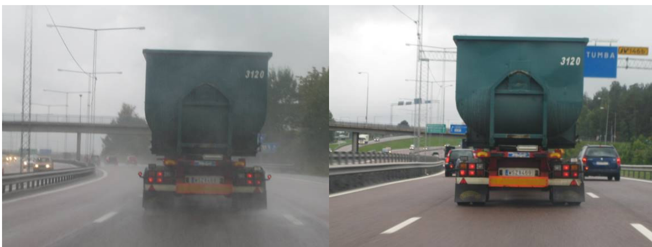
Figur 2. Effekt av dränerande beläggning (ABS16 till vänster och TA9 till höger)
