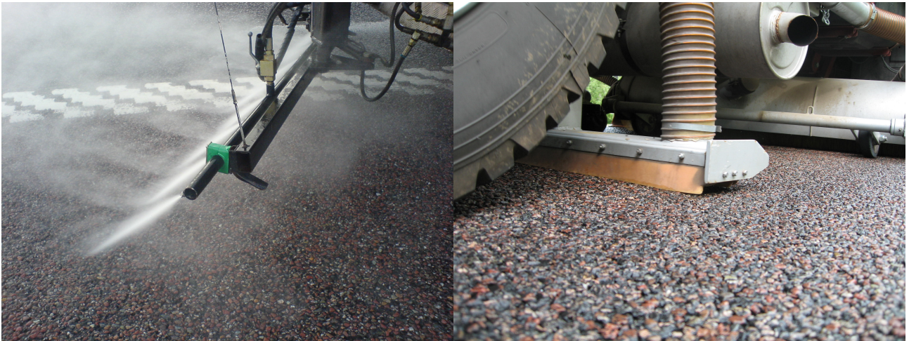
Figur 10. Frontmonterad spolramp samt sugaggregat (Stivab, Disab-Tella AB).
