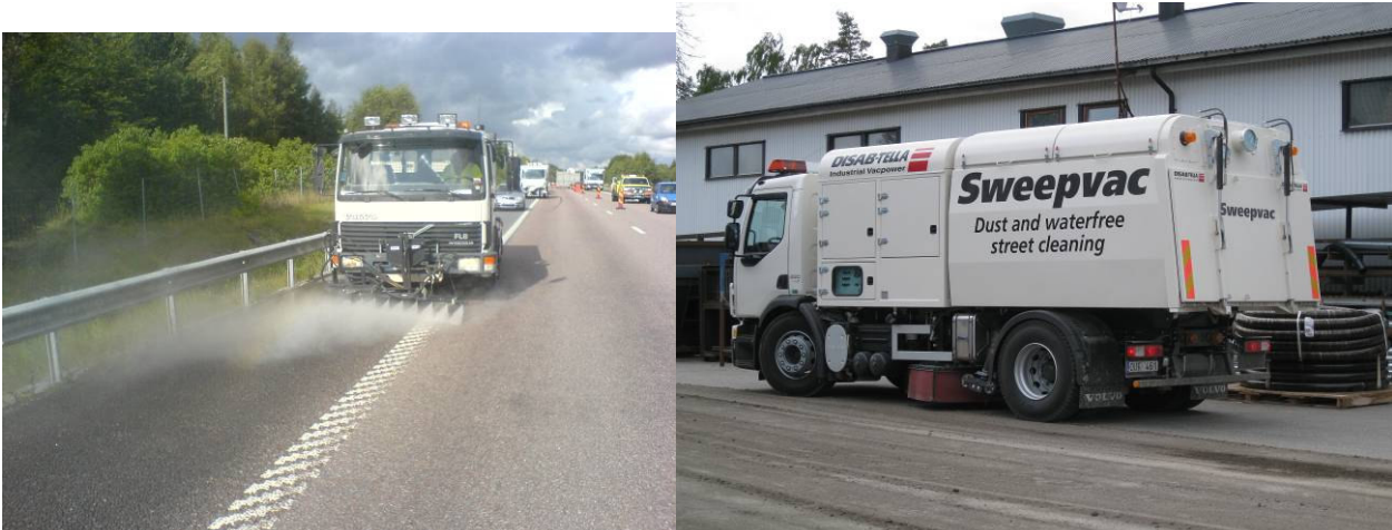
Figur 9. Exempel på separat spol- och sugfordon (Stivab, Disab-Tella AB).
