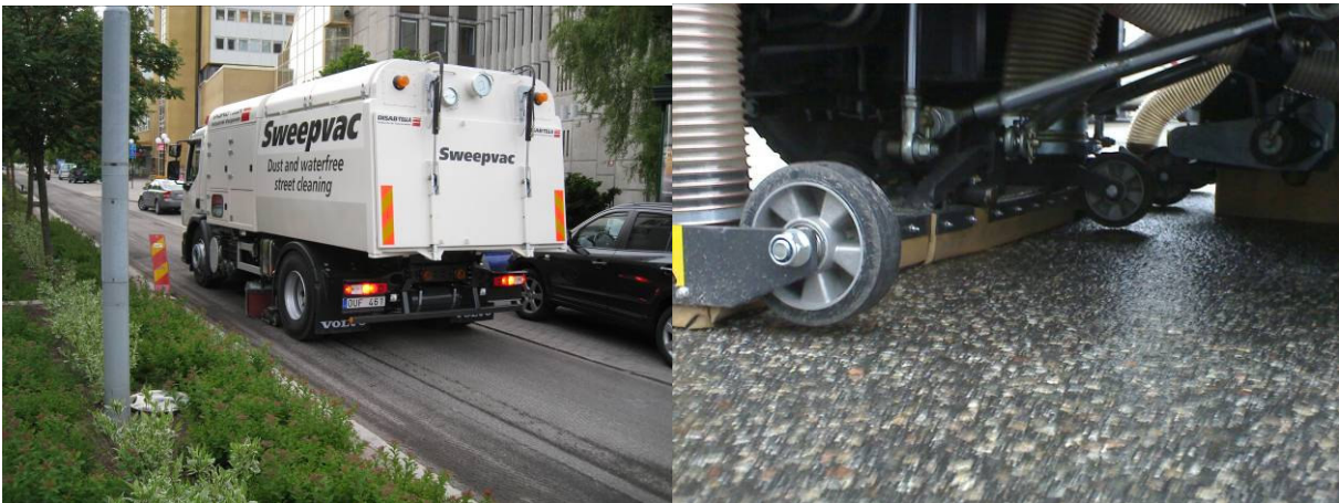
Figur 11. Rengöring av fräslåda samt ledat sugmunstrycke (Disab-Tella AB)
